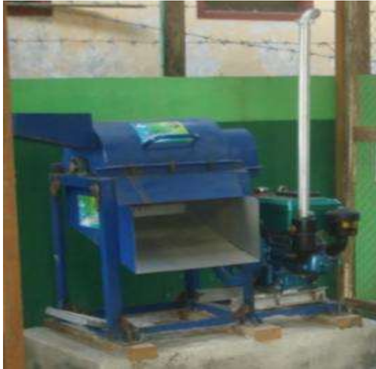
Gambar 5. Mesin pencacah sampah SDN Tunjungsekar I
